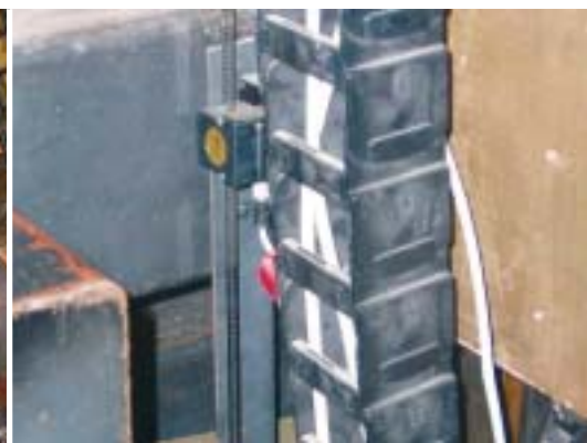
ONERA akustisches Kammer : Positionierung von Mikrofonen entlang Düsenmotoren
